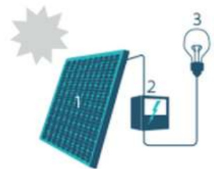
1. Zonnepaneel | 2. Omvormer | 3. Elektrische toestellen
